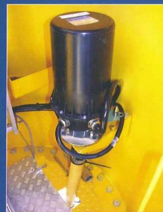
Collettore elettrico. Assicura il collegamento elettrico tra porta ralla fisso e porta ralla rotante. Il numero di giri in rotazione non è limitato (sui modelli senza collettore, rotazione limitata a due giri per ogni senso di rotazione).
