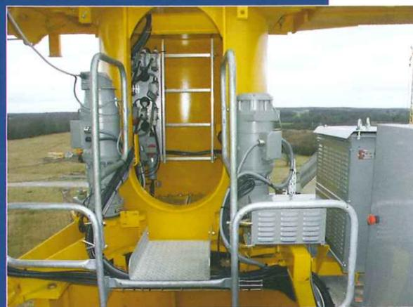
RVF (rotazione a variazione di frequenza) in versione Optima+. L'Optima+ consente due possibilità di manovra. La prima una manovra convenzionale. La seconda consente una frenata programmata mediante contro-manovra.
