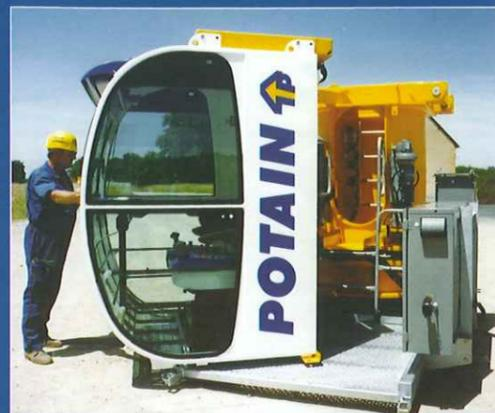
4 | Dopo rimozione del parapetto, rotazione manuale della cabina |
