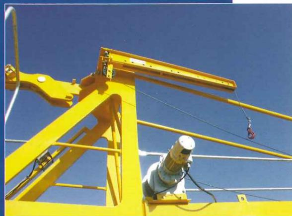
Falconcino di manutenzione previsto di serie. Può essere meccanizzato mediante un argano ausiliario. Carico massimo 450 DaN
