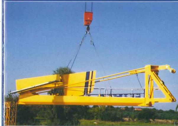
Un solo collo, ripiegato per il trasporto, con segnalazione punti di imbracatura. Un design inedito e brevettato.
