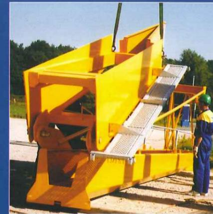
Apertura rapida del controbraccio. Non è necessaria alcuna operazione di serraggio.
